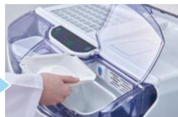
auto onedy-zero秤量皿のRFIDをユヤマ各種分包機で読み込むことで、処方データを簡単に呼び出しできます。処方入力間違いを防止し安全な分包が可能になります。
