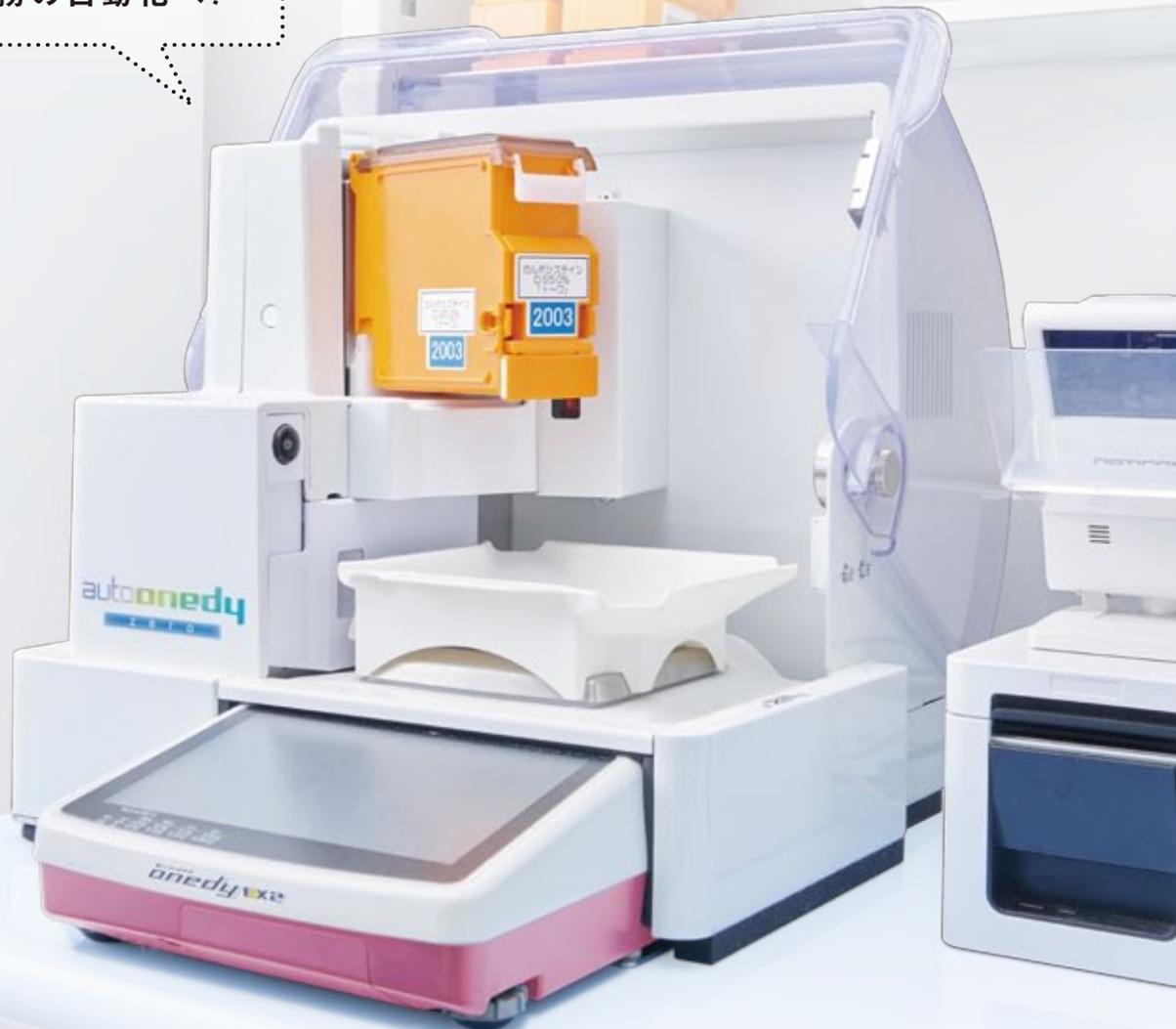
鑑査システム一体型自動散薬秤量機
