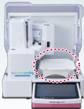
秤量業務開始時には秤量皿を置くようにアナウンスされます。秤量皿のみの重量値は予め記憶させているので、万が一お皿に別薬品などが載っていたら…「**秤量皿に異物が載っている**」旨のエラーが表示されるので払い出しが開始されません。
